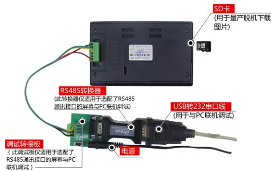
图 1-5 RS485 调试工具图
